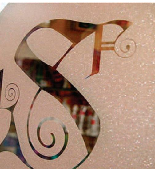
Film in PVC cast fuso per la decorazione dei vetri, spessore 80  $\mu\text{m}$ , supporto in poliestere spessore 100  $\mu\text{m}$  ed adesivo in poliacrilato solvente permanente trasparente; ha un'ottima resistenza agli UV ed alle intemperie è disponibile in 5 diversi colori con una superficie dalla ridotta lucentezza che ne limita gli effetti riflettenti.
